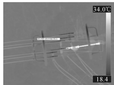
图 2 直升机测温 1250 号发热点图片
